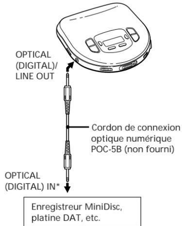
\*Si la prise OPTICAL (DIGITAL) IN présente une forme carrée, utilisez plutôt le câble de raccordement POC-5AB.
